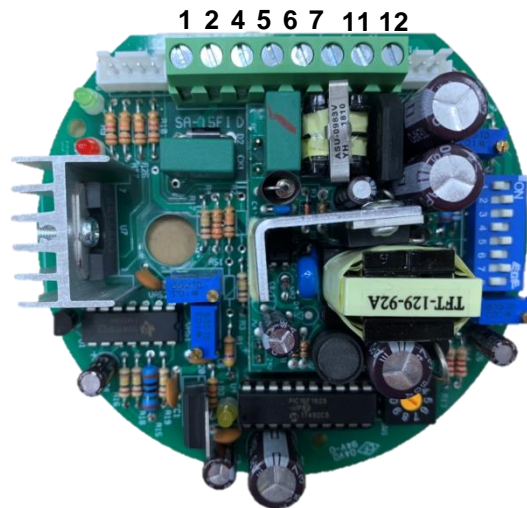
電圧110/220VAC用の比例制御基板
